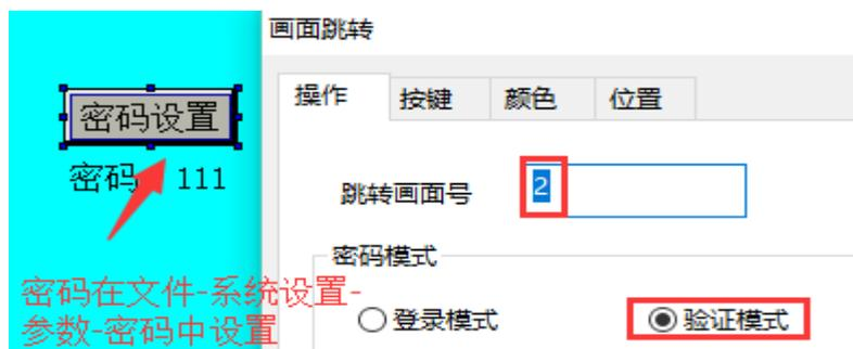
画面 2: 到期时间、密码设置画面。放置 3 个数据输入, 地址 PFW260、PFW261、PFW262, 16 进制输入; 1 个字符输入, 地址 PFW350, 寄存器数为 3; 放置 1 个指示灯按钮, 地址 PFW256.0。如下:
