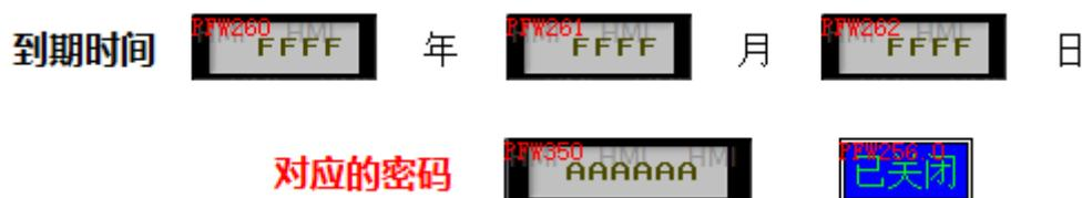
画面 3: 到期后密码输入画面。放置 1 个字符输入, 地址 PSW256, 寄存器数为 3; 放置一个功能键调用 jiemi 函数。如下:
