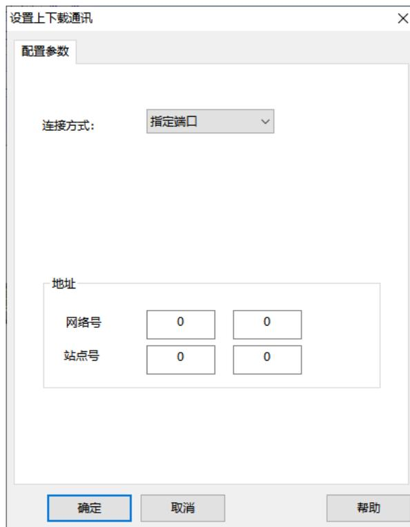
使用指定端口下载需要将触摸屏和电脑用网线连接，并将屏的 IP 地址和电脑的 IP 地址设为同一网段内（设置方式参考局域网下载）。此方式下下载程序，上下载协议栈选择“指定端口”。此处的地址的 IP 与屏的 IP 地址保持一致即可下载程序。
